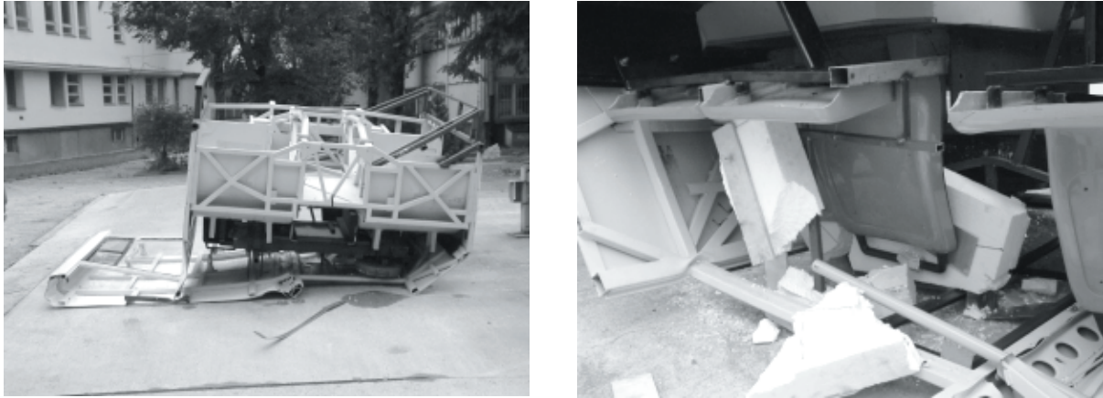
Rys. 7. Negatywny wynik uzyskany podczas przewracania segmentu nadwozia autobusu
