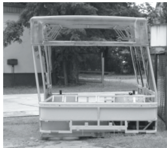
Rys. 6. Deformacja przedniej części autobusu po jej przewróceniu (segment potrójny) Fig. 6. Deformation of the front bus section after the rollover test (triple body section)
