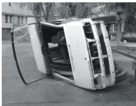
Rys. 12. Deformacja przedniej i tylnej części nadwozia adaptowanego na bazie furgonu Mercedes Sprinter po przewróceniu zgodnie wymaganiami Regulaminu (wynik pozytywny)
