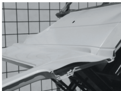
Rys. 13. Negatywny wynik uzyskany podczas przewracania segmentu nadwozia pokazanego na Rys. 12
