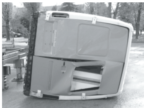
Rys. 12. Deformacja przedniej i tylnej części nadwozia adaptowanego na bazie furgonu Mercedes Sprinter po przewróceniu zgodnie wymaganiami Regulaminu (wynik pozytywny)
