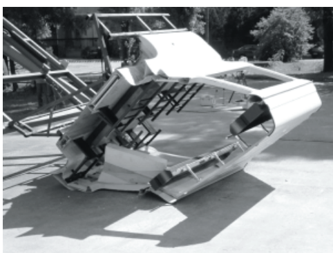
Rys. 13. Negatywny wynik uzyskany podczas przewracania segmentu nadwozia pokazanego na Rys. 12
